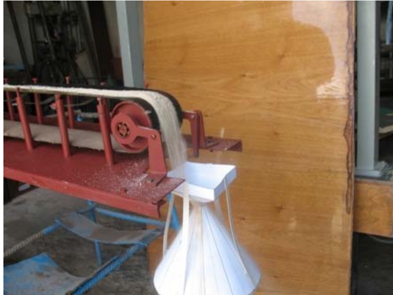
Рисунок 3 – Модель узла разгрузки ленточного конвейера
