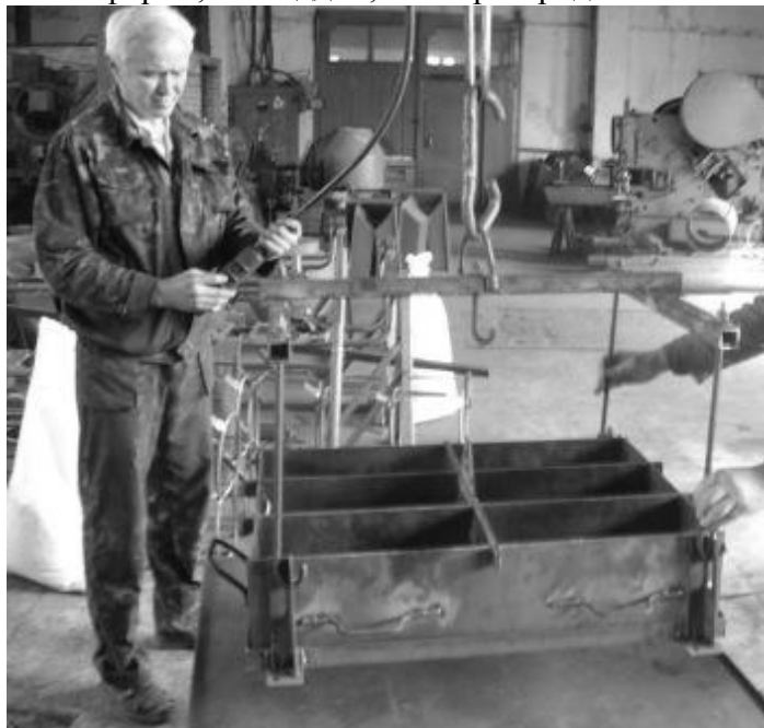
Рисунок 2 – Транспортування форми за допомогою спеціальної траверси
