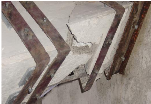
Рисунок 6 – Схема виколування арматури експериментальної балки
