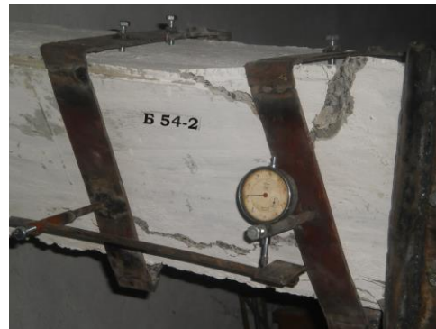
Рисунок 7 – Схема руйнування експериментальних балок – по просторовій тріщині кручення в верхній полиці (на прикладі балки Б 54-2)
