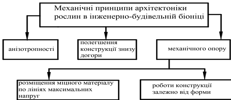
Рисунок 5 – Схема механічних принципів інженерно-будівельної біоніки
