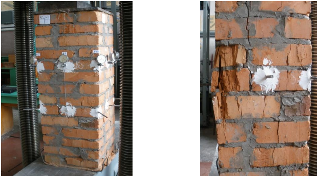
Рисунок 1 – Зразок С.3-1 цегляного стовпа в пресі ПММ–500 для випробування та його вигляд при руйнуванні вздовж ребра в місці розташування індикатора И-2
