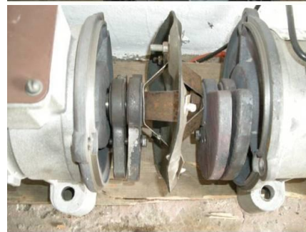
Рисунок 10 – Експериментальна установка: а – конструктивна схема (1 – форма; 2, 3 – віброзбудники коливань; 4 – основа для кріплення збудників коливань; 5 – нижня рама; б – опори); б – загальний вид установки та вібраторів в зібраному вигляді.
