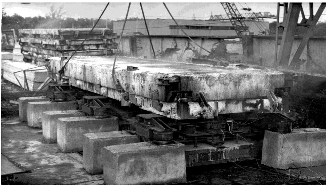
Рисунок 8 – Електромагнітний вібромайданчик з керованим режимом роботи: а) – схема вібромайданчика, 1 - форма; 2 - опорні амортизатори; 3- робочий орган; 4 – статор електромагніта; 5 - котушка електромагніта; 6 - пружний зв'язок; 7 - ударник; 8 - електромагніт; 9 - буфер; 10 - індукційний датчик; 11 - прапорець; 12 - елемент зворотного зв'язку; 13 - блок живлення; б) – загальний вигляд.
