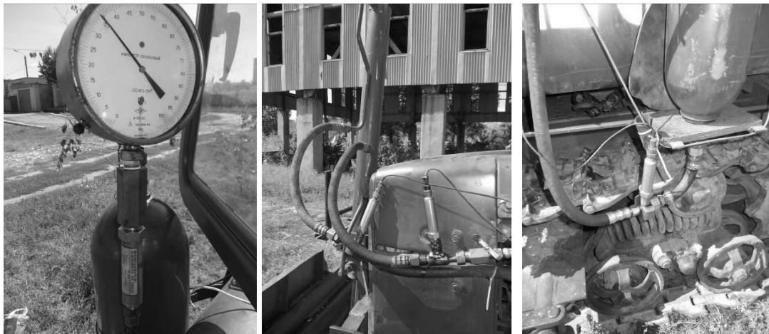
Рисунок 4 – - Расположение датчиков в гидросистеме бульдозера
