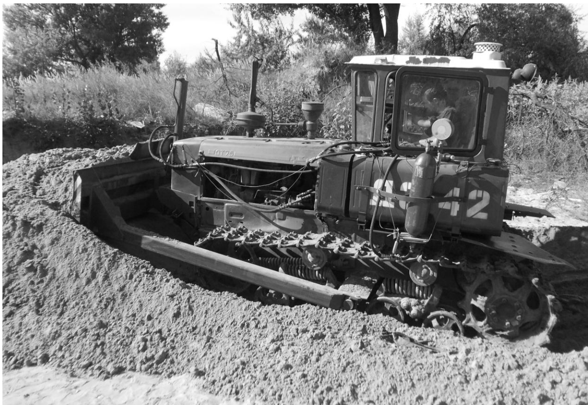
Рисунок 2 – Бульдозер ДЗ-42Г с системой аккумуляирования энергии
