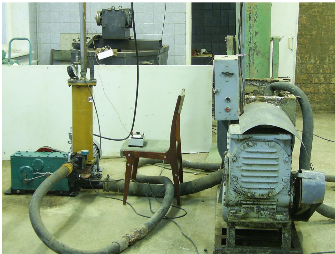
Рисунок 1 – Експериментальний стенд для визначення інтенсивності видалення повітря з ковпака при перекачуванні розчинів рухомістю ОК 8, 10, 12 см і при середніх тисках подачі p = 0,9 МПа, p = 1,2 МПа, p = 1,7 МПа: а – конструктивна схема:
