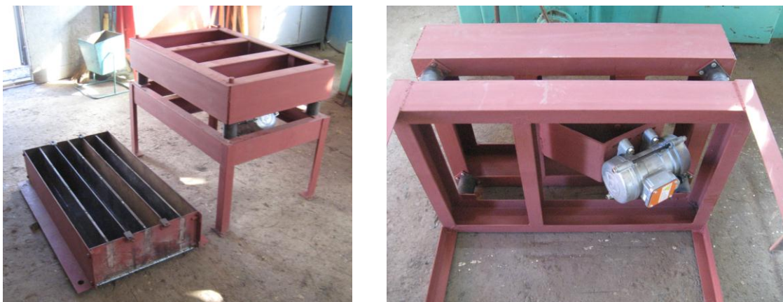
Рисунок 3 – Віброустановка з формою для виготовлення поребриків
