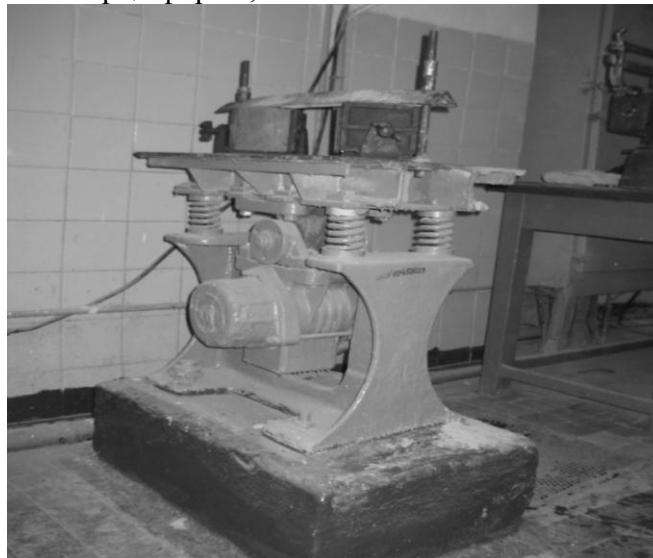
Рисунок 1 – Формування зразків ґрунтоцементу на лабораторній віброплощині.
