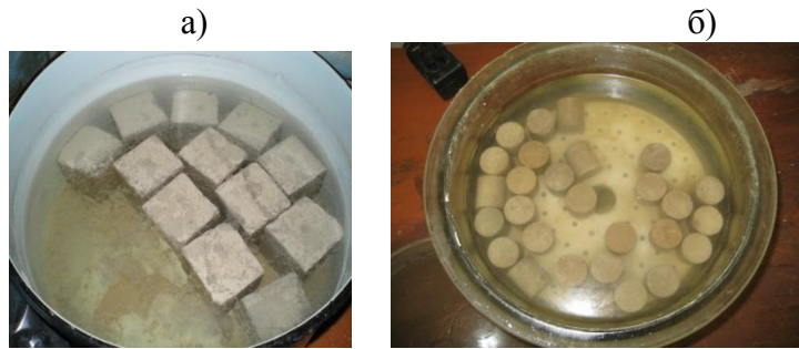
Рисунок 3 – Зберігання готових зразків ґрунтоцементу у воді: а – кубики; б – циліндри
