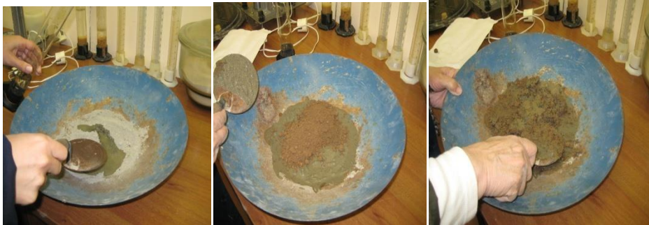
Рисунок 1 – Виготовлення цементного розчину та ґрунтоцементної суміші
