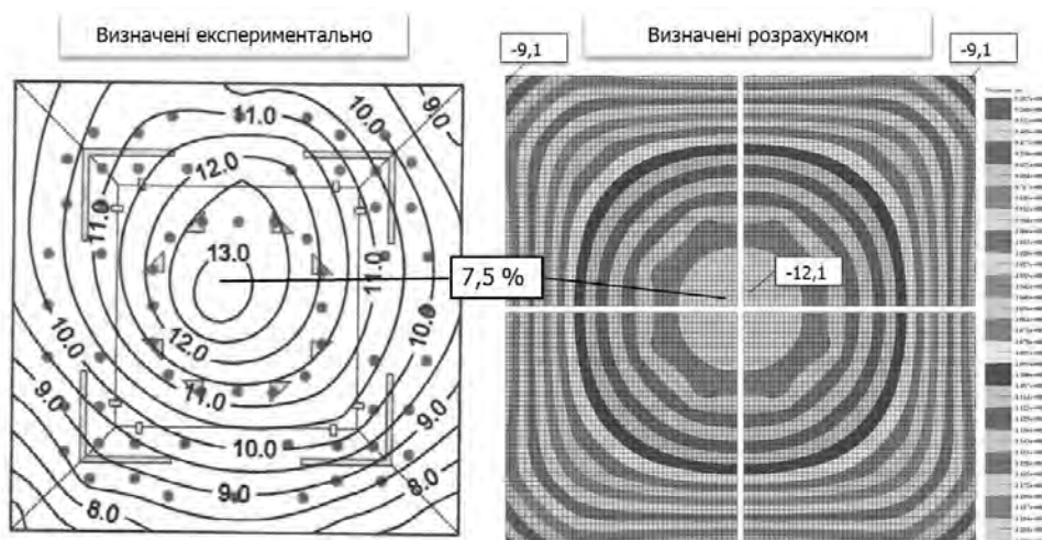
Рисунок 5 – Вертикальні деформації фундаментної плити, см
