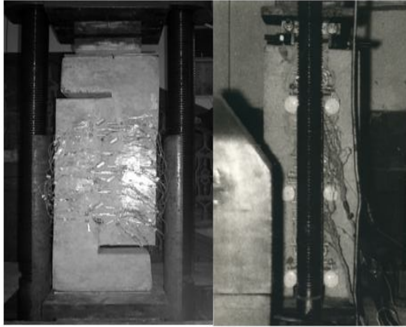
Рисунок 10 – Випробування тришпонкових зразків у пресі ПП-125: а – із змінною шириною шва; б – контактний стик
