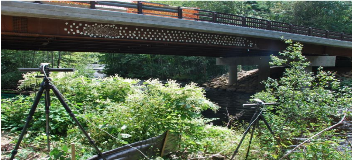
Рисунок 7 – Обладнання ЦКЗ, встановлене на середньому прогоні моста
