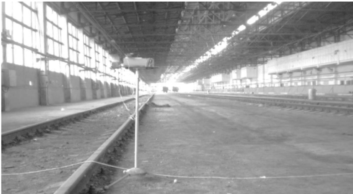
Рис. 4. Вимірювання природного освітлення в розрахункових точках горизонтальної УРП у приміщенні будівлі депо
