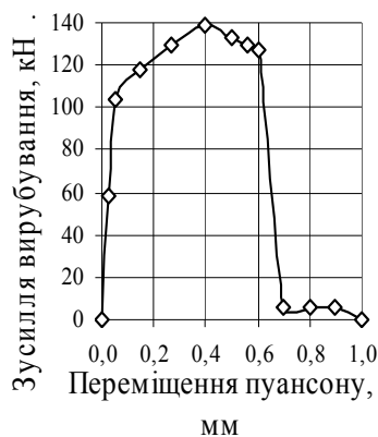
Рис. 3. Залежність зусилля вирубування від переміщення пуансону
