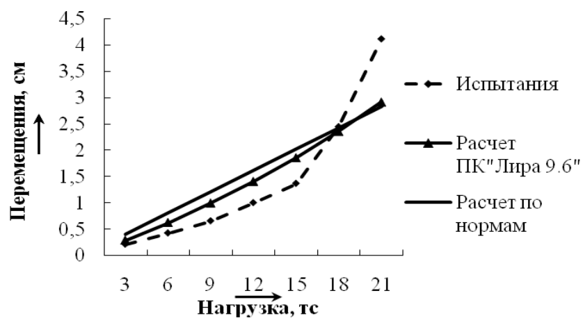
Рис. 4. График увеличения фактических и расчетных перемещений головы сваи в зависимости от горизонтальной нагрузки
