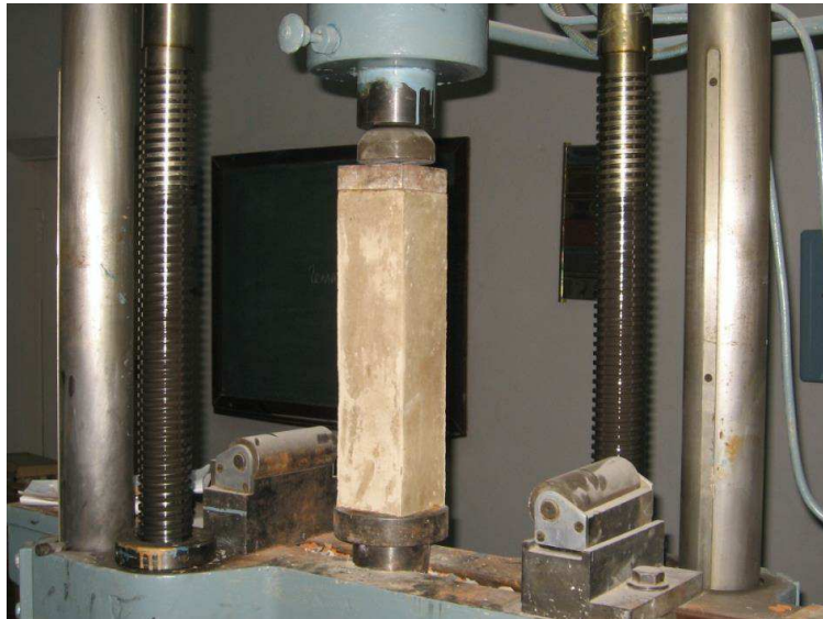
Рис. 3. Випробування армованих ґрунтоцементних призм на осьовий стиск
