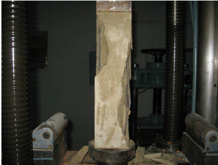
Рис. 4. Характер руйнування армованих ґрунтоцементних призм
