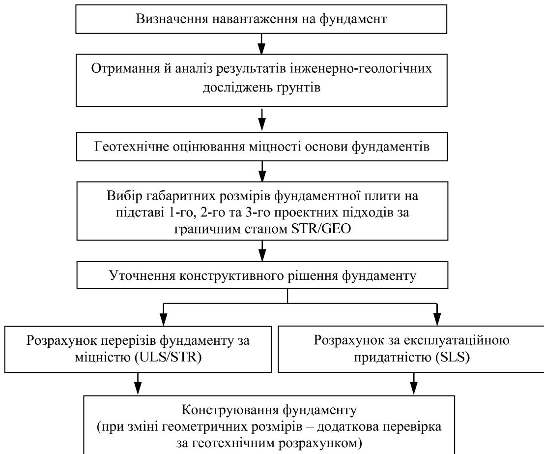
*Рис. 2. Загальна процедура проектування плоских (плитних) фундаментів*
