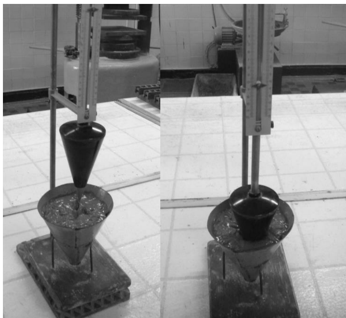
Рис. 4. Визначення рухливості ґрунтоцементу зануренням конуса
