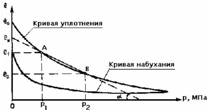
Рис. 2. Результаты компрессионных испытаний в одометре
