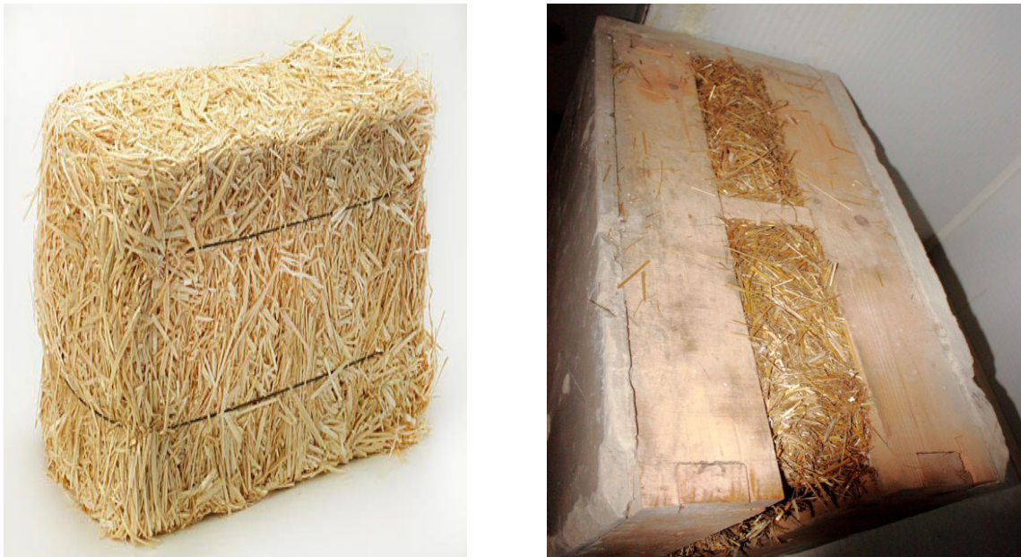
Рис. 1. Солом'яний блок без опоряджувального шару та з опоряджувальними шарами складного розчину
