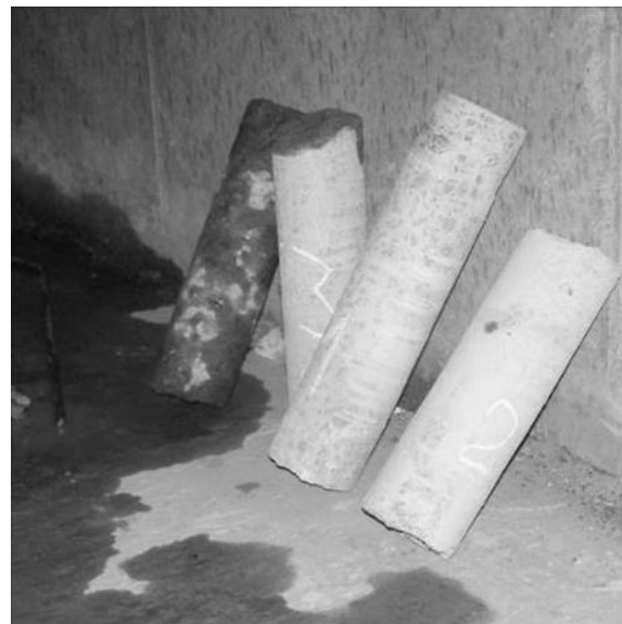
Рис. 3. Керни, висвердені з фундаментної плити установкою Hilti
