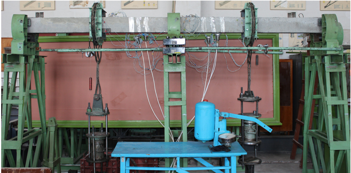
Рис. 3. Загальний вигляд установки для випробування нерозрізних балок
