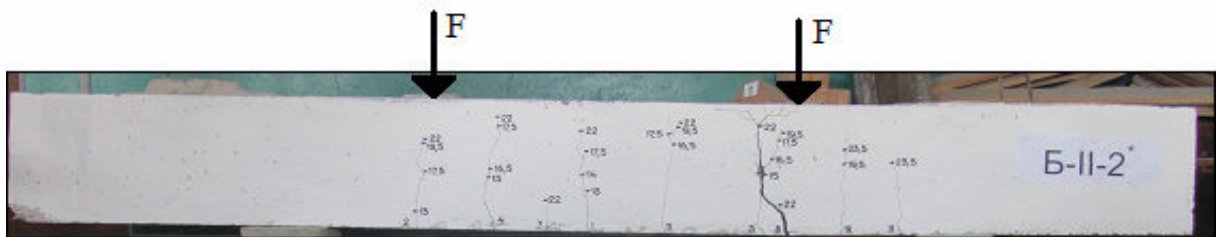
Рис. 7. Характер утворення тріщин та руйнування у дослідних зразках: а) Б-II-2; б) Б-II-2*
