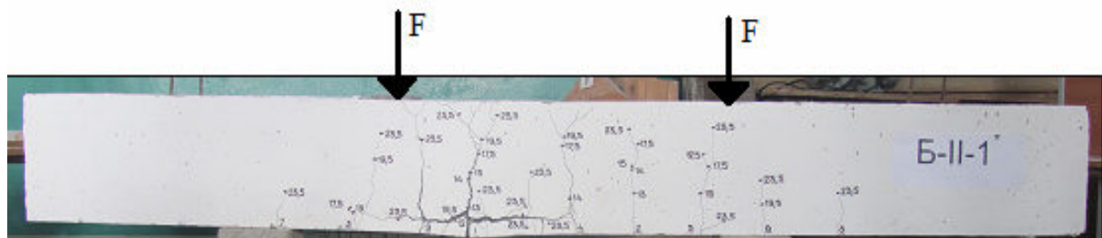
Рис. 6. Характер утворення тріщин та руйнування у дослідних зразках: а) Б-II-1; б) Б-II-1*
