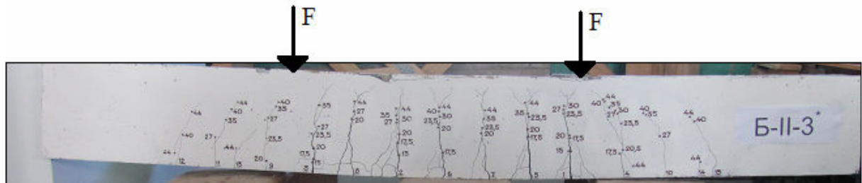
Рис. 8. Характер утворення тріщин та руйнування у дослідних зразках: а) Б-II-3; б) Б-II-3*
