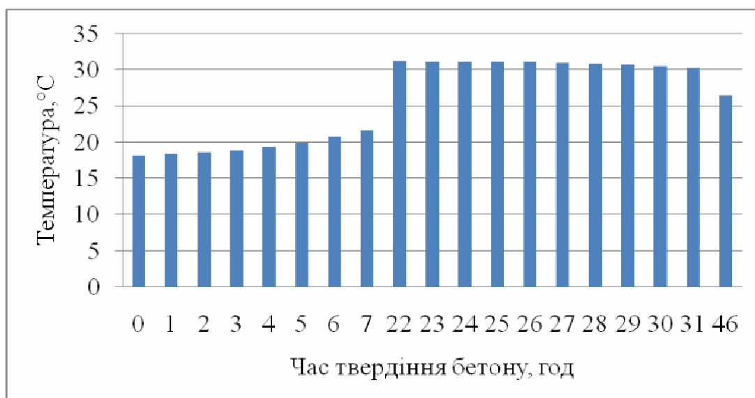
Рис. 1 – Зміна температури тверднучого в теплоізоляційному боксі важкого бетону (В/Ц = 0,65)
