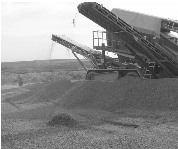
Рис. 3. Пылеобразование при дроблении шлакового щебня в пределах допустимого
