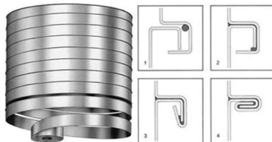
Рис. 5 – Схема процесу подвійного фальцювання сталевих стрічок спірального силоса
