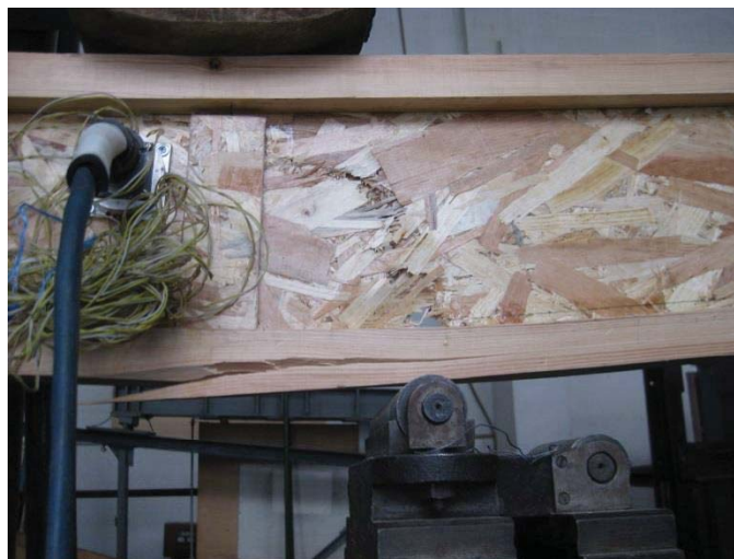
Рис. 8 – Характер руйнування дерев'яної балки
