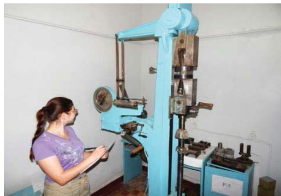
Рис. 2 – Випробування зразків ґрунтоцементу на міцність
