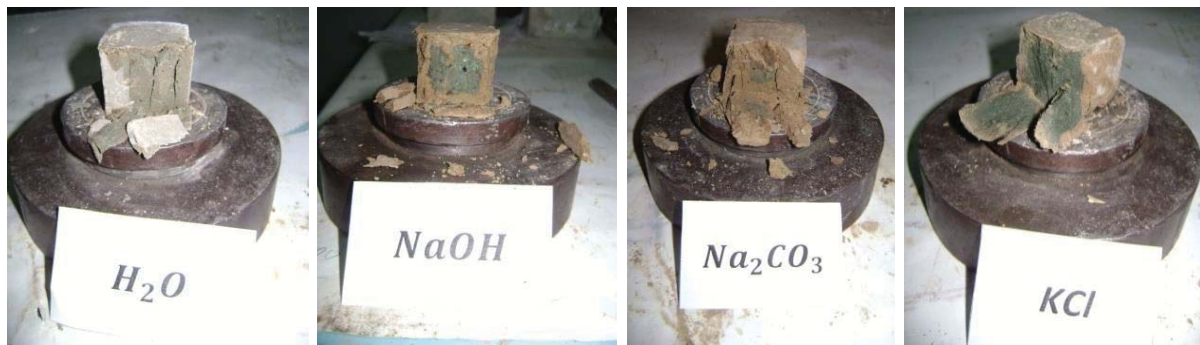
Рис. 3 – Зразки ґрунтоцементу після випробування на міцність залежно від середовища витримки
