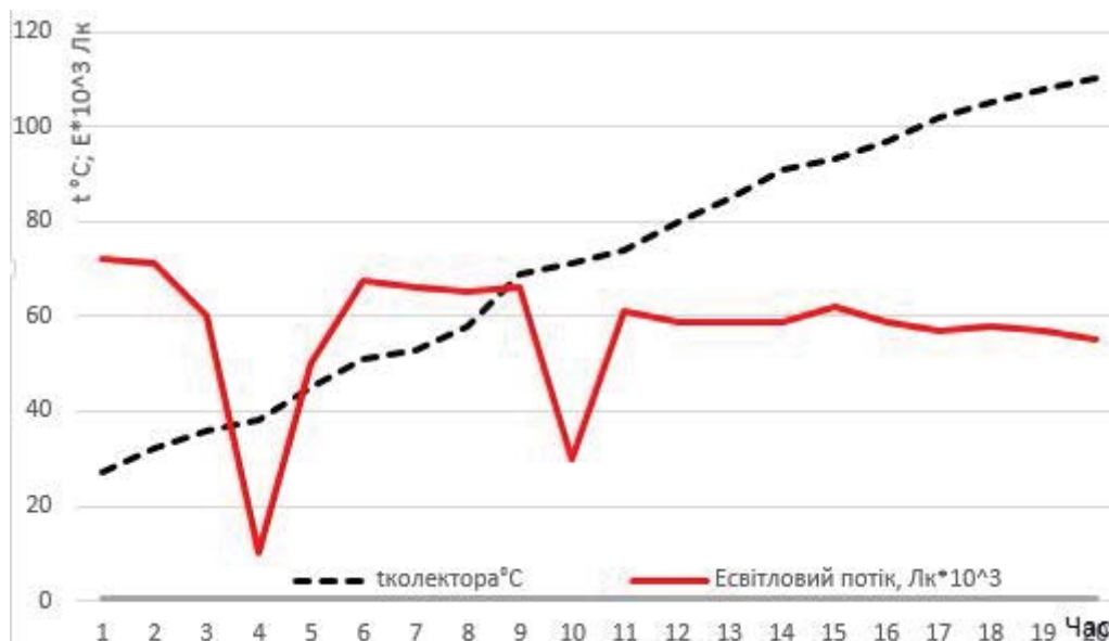
Рис. 4 – Графік нагрівання установки в режимі стагнації
