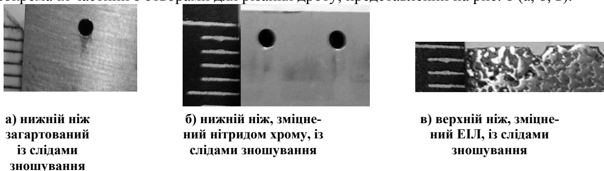
Рис. 8. Вигляд ножів для різання дроту
