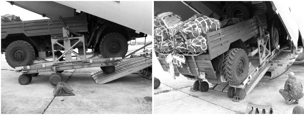
Рисунок 8 – Погрузка грузового автомобиля на платформе П-7 при помощи съемных трапов, закрепляющихся на рампе
