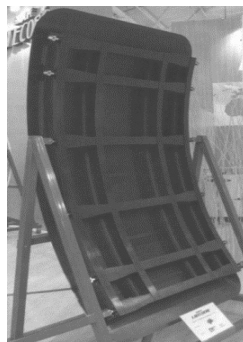
Рисунок 5 – Пассажирская дверь, разработанная фирмой Latécoere в рамках европейской программы Maximus
