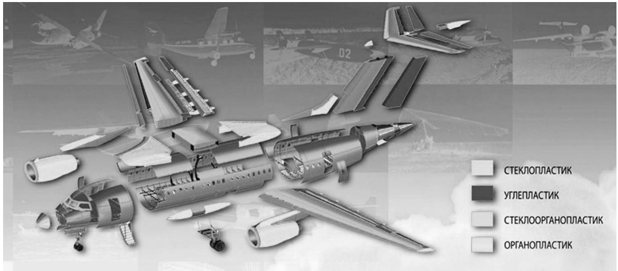
Рисунок 3 – Применение ПКМ в конструкции самолетов Ан-148/158
