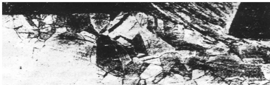
Рис.6 Структура пластически деформированной зоны стали 9ХС (увеличение 100)
