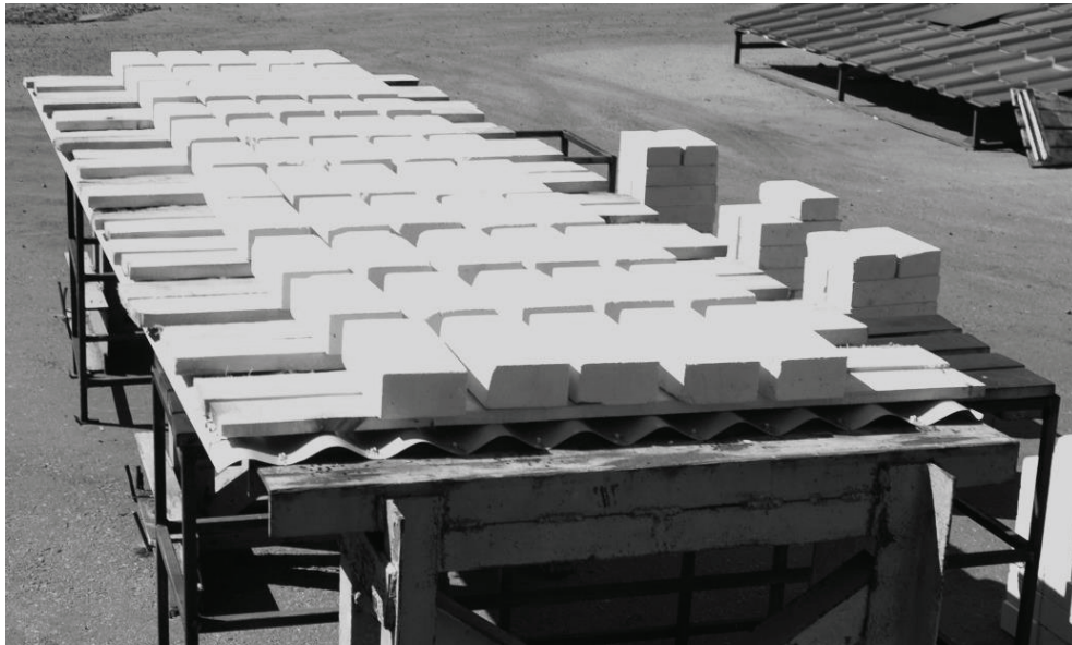
Рисунок 3 – Рівномірне прикладення навантаження на зразок
