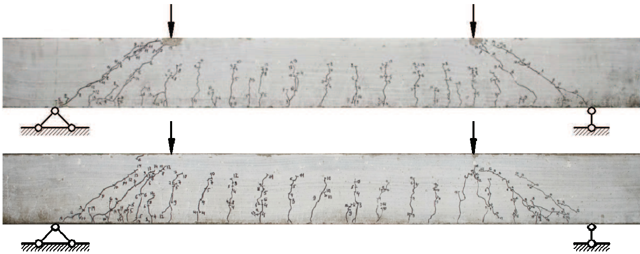
Рисунок 2 – Механизм трещинообразования в опытном образце-балке со средним пролётом среза при статическом пропорциональном однократном нагружении
