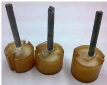
Рис. 11. З'єднані деталі за допомогою склоіономерного цементу Fuji Plus (Японія)
