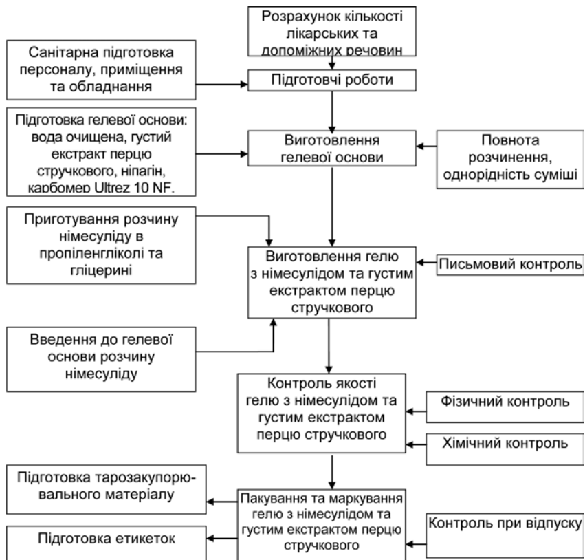
Рисунок. Схема технології гелю з німесулідом та густим екстрактом стручкового перцю в умовах аптечного виробництва.
