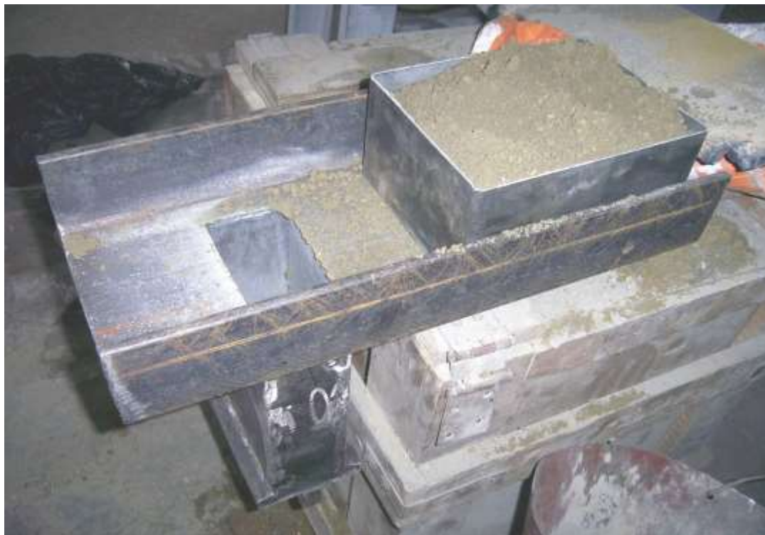
Рис. 3. Стенд для досліджень впливу вологості на густину й похибку засипки сировинної суміші у прес-формі
