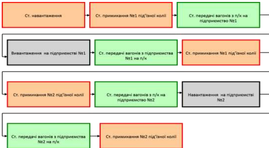
Рисунок 2 - Схема обігу вагона при існуючій технології роботи станцій примикання та під'їзної колії ППЗТ
