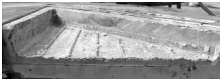
Рис. 9. Розкрита після випробувань порожнина зразка СПБ50
