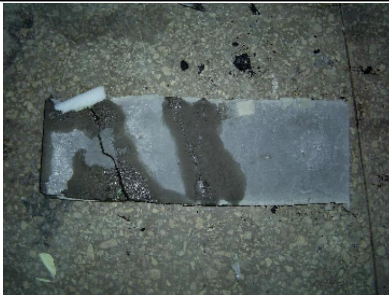
Рис. 7 Прокладний шар із SikaGrout-316 після завершення динамічних випробувань і розбирання моделі: поверхня, контактна з бетоном плити БМП – при розбиранні моделі прокладний шар по наскрізній тріщині роздівся на окремі частини, мастило просочило прокладний шар в районі волосяної тріщини.
