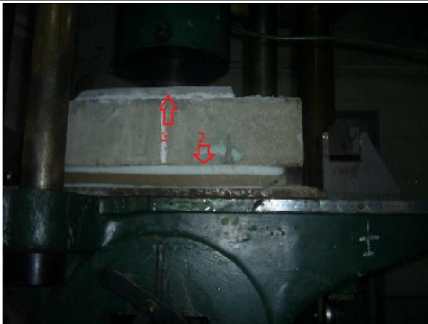
Рис. 8 Випробування складу із епоксидної композиції Sikadur-42 HE. (1 - склад Sikadur-42 HE; 2 – склад з нижньої сторони моделі).
