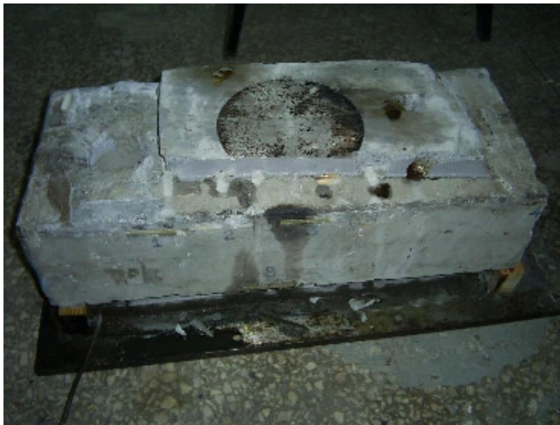
Рис. 9 Прокладний шар із епоксидної композиції Sikadur-42 HE після завершення динамічних випробувань і розбирання моделі
