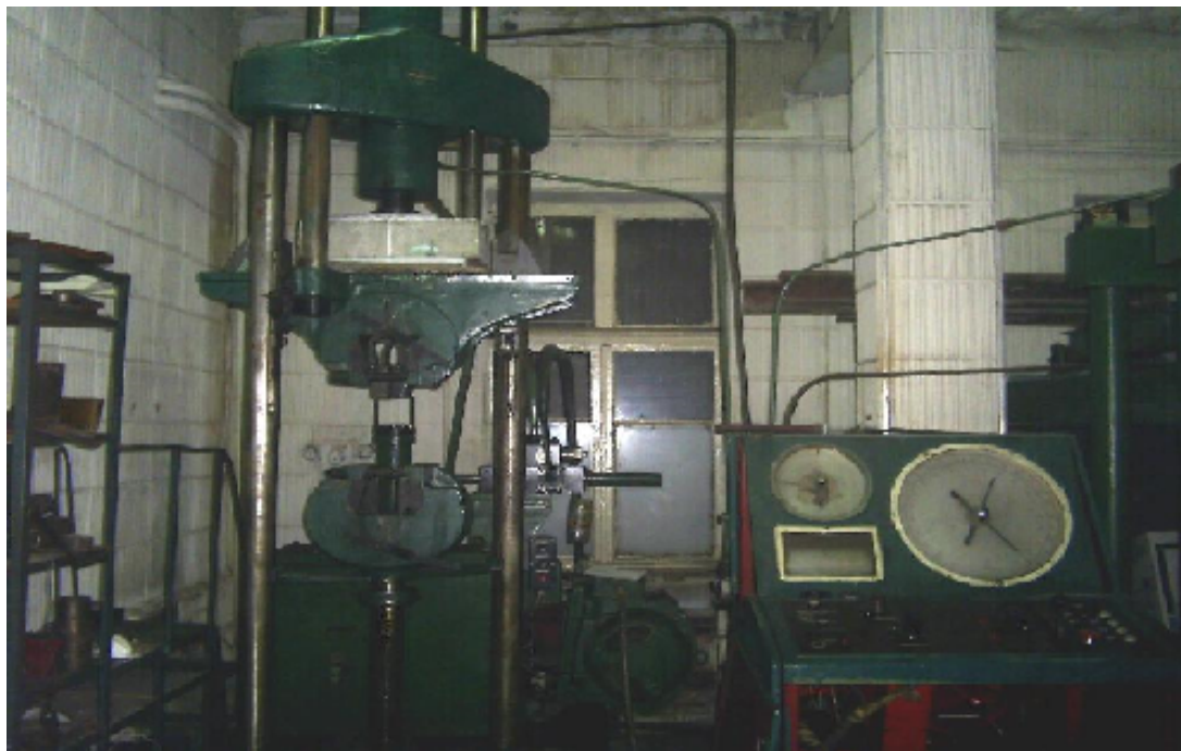
Рис. 1 Динамічні випробування масштабної моделі вузла сполучення верхньої полиці подовжньої балки моста, прокладного шару і плити БМП за допомогою випробувальної машини МУП-50
