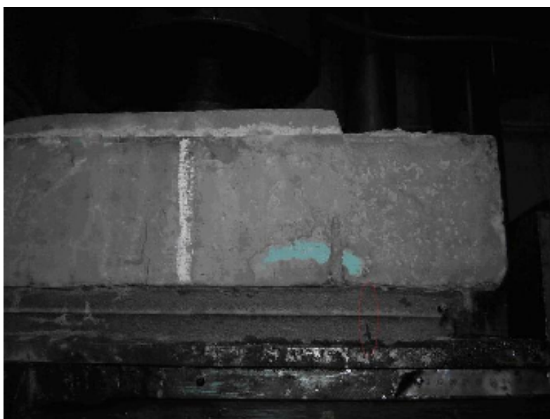
Рис. 2 Утворення у прокладному шарі з Emaco Fast Fluid поперечної тріщини після 376,5 тис. циклів динамічних випробувань
