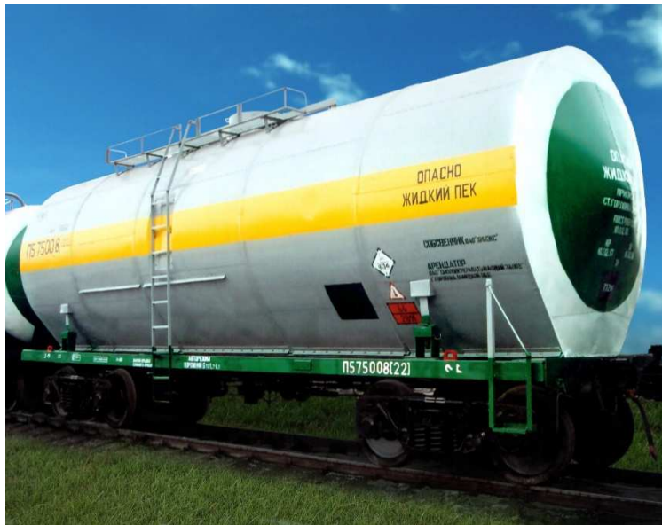
Рис. 2. Спеціалізований вагон-цистерна для пеку моделі 15-1534-03 побудови ПАТ «Азовмаш»
