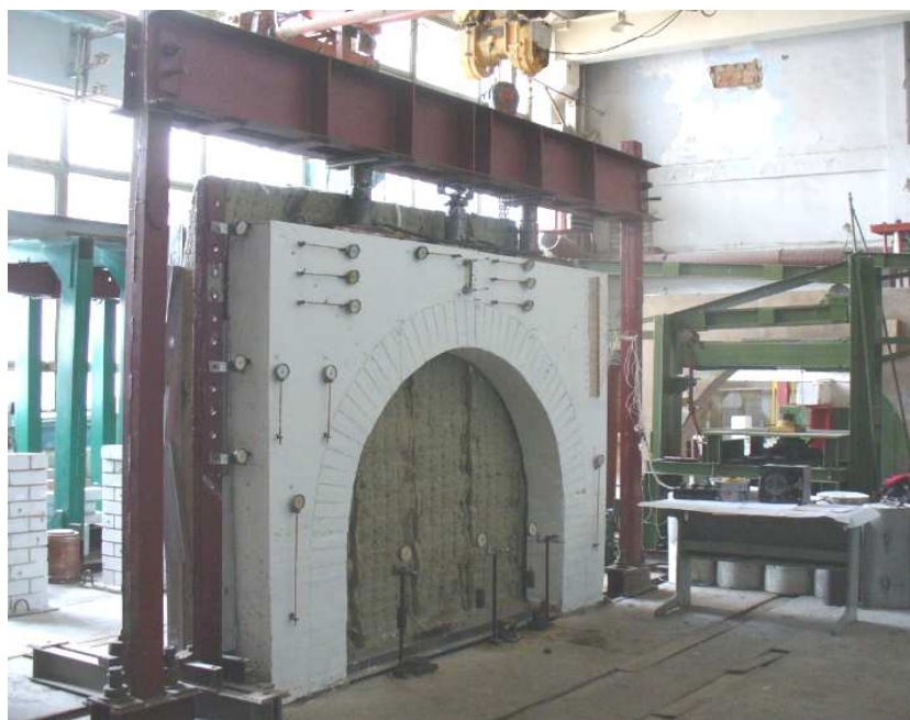
Рис. 1. Фрагмент №1 в виде бора с футеровкой шамотным кирпичом и силовая металлическая рама для создания вертикальной нагрузки
