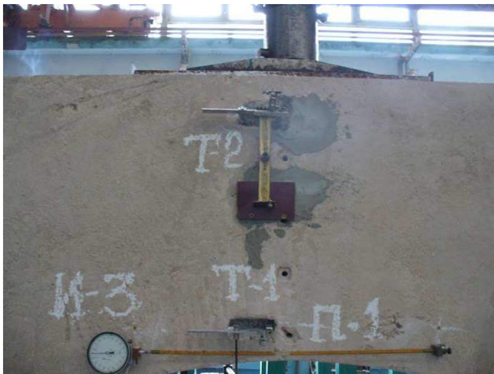
Рис. 9. Установка рычажных тензометров Т1-Т2 на верхней и нижней арматуре
