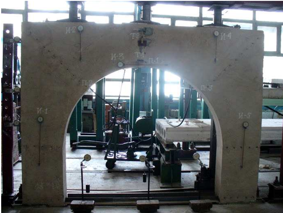
Рис. 8. Расстановка индикаторных тензометров И1-И5 на бетон, рычажных тензометров Т1-Т2 на верхней и нижней арматуре и прогибомеров П1-П6 в железобетонном фрагменте фундамента №2 без футеровки борава
