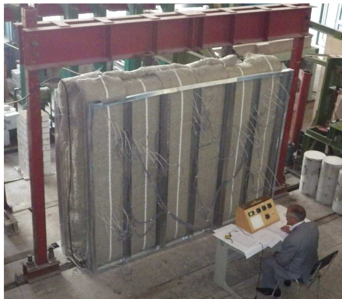
Рис. 2. Раздвижные рамы с теплоизолятором - матами из минеральной ваты для создания двумерного температурного поля в образце
