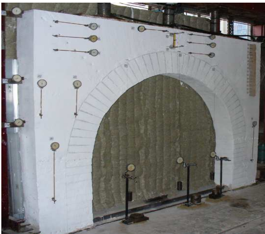
Рис. 5. Загрузка фрагмента фундамента №1 с футеровкой борова
