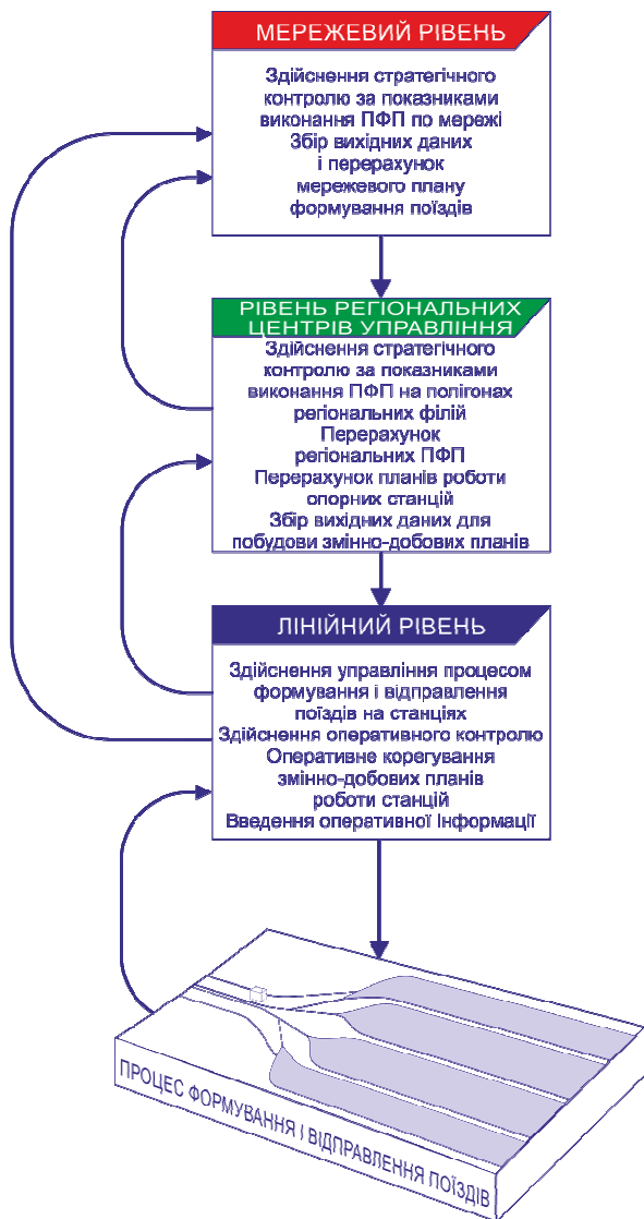
Рис. 4. Контур управління автоматизованої системи управління вагонопотоками на залізницях України
