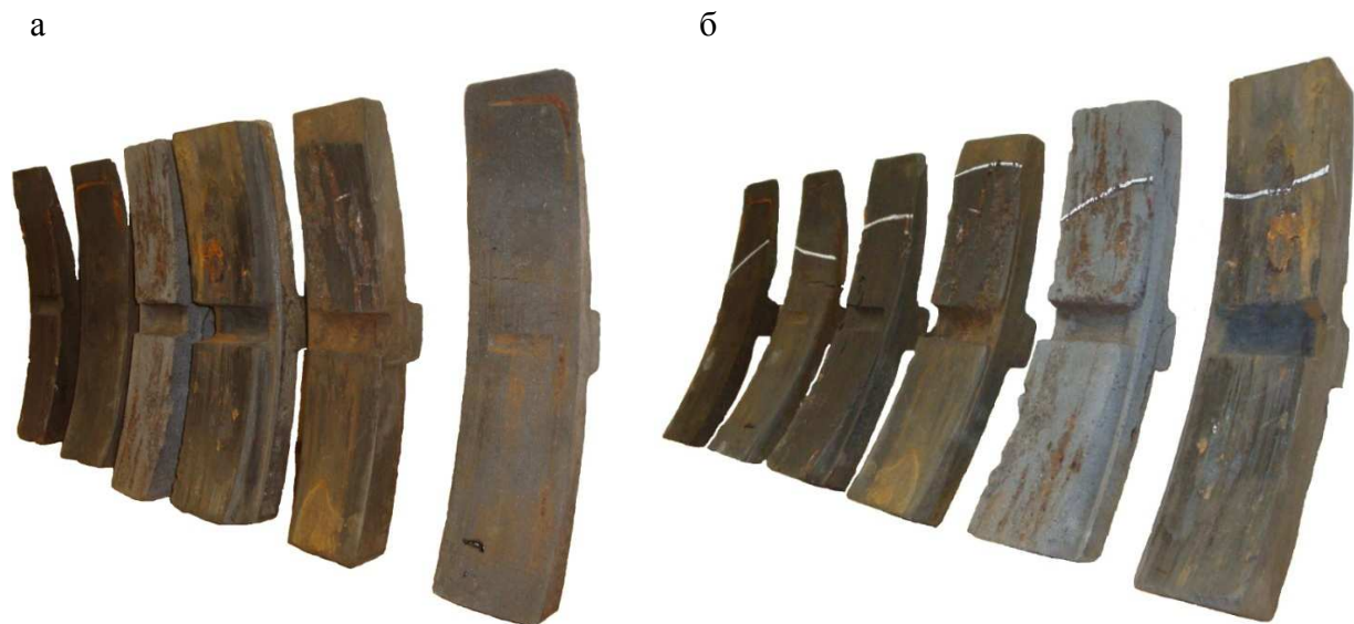
Рис. 1. Гальмові колодки, демонтовані з вантажних вагонів, які непридатні до подальшого використання через подвійний знос, але ще з великими залишками робочого тіла:
