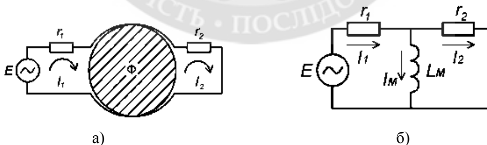
Рис. 2. Трансформатор з повним перекриттям обмоток (а) та його еквівалентна схема (б)
