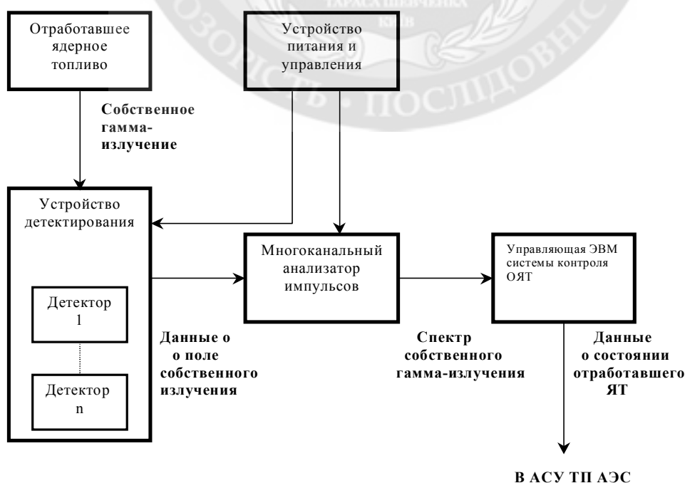
Рис. 1. Структурная схема системы контроля состояния отработавшего ядерного топлива в реальном времени
