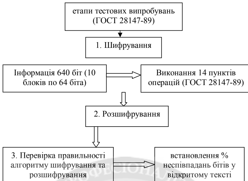
Рис. 2. Етапи тестових випробувань стійкості ПЗ ІС до несанкціонованих впливів
