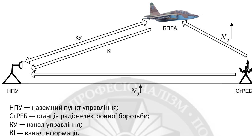
Рис.1. Вплив засобів РЕП на канали управління БПЛА
